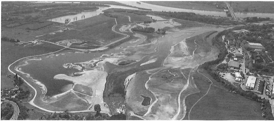
Abb. 7: Die erweiterte, tiefergelegte und neu gestaltete Aue im Bereich der Lippemündung in den Rhein (im Hintergrund) bei Wesel. Gut zu erkennen sind die vielfältigen und flach auslaufenden Ufer in den Auenbereichen sowie die vielgestaltige Reliefgestaltung durch die Lippe im Strom. Foto: Emschergenossenschaft/Lippeverband
