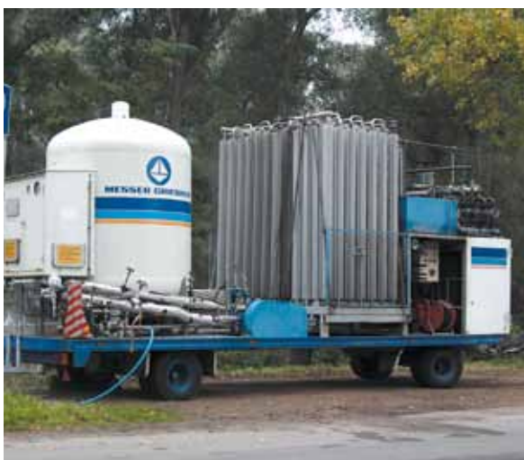
Sauerstofftank und Kaltvergaser, um Sauerstoff in das Tiefenwasser des Roxheimer Altrheins einzuleiten.
